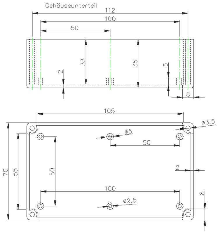
Gehäuseunterteil schwarz mit innenliegenden Befestigungsmöglichkeiten für Platinen.
